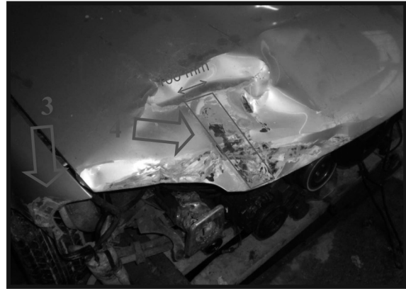
Slika 4. Oštećenja na vozilu VW Passat - DETALJ
