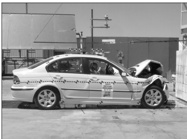
Slika 1. Nalet vozila BMW 325 I na čvrstu prepreku
