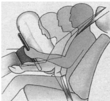
Заштита возача синхронизованим дејством појаса сигурности са затезачем и Аирбагом
