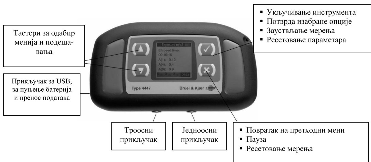
Слика 2 - Четири контролна тастера на предњој страни уређаја служе за руковање апаратом
