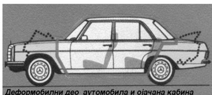
Деформобилни део аутомобила и ојачана кабина
